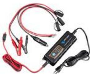
Герметичные, с классом защиты IP65 зарядные устройства выполнены в корпусе из ударопрочного пластика. Устройство имеет 4-х ступенчатую зарядную характеристику, пять светодиодов для индикации режимов работы и кнопку выбора одного из трех профилей заряда. Два уровня тока заряда выбирается пользователем 0,8 или 4А.
